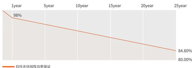
※自系统安装并正常运行第一年, 输出功率不小于该产品说明书所述最低输出功率的 98%; 以后每年输出功率最大衰减 0.55%; 25 年后产品输出功率不小于其说明书所述最低输出功率的 84.8%
